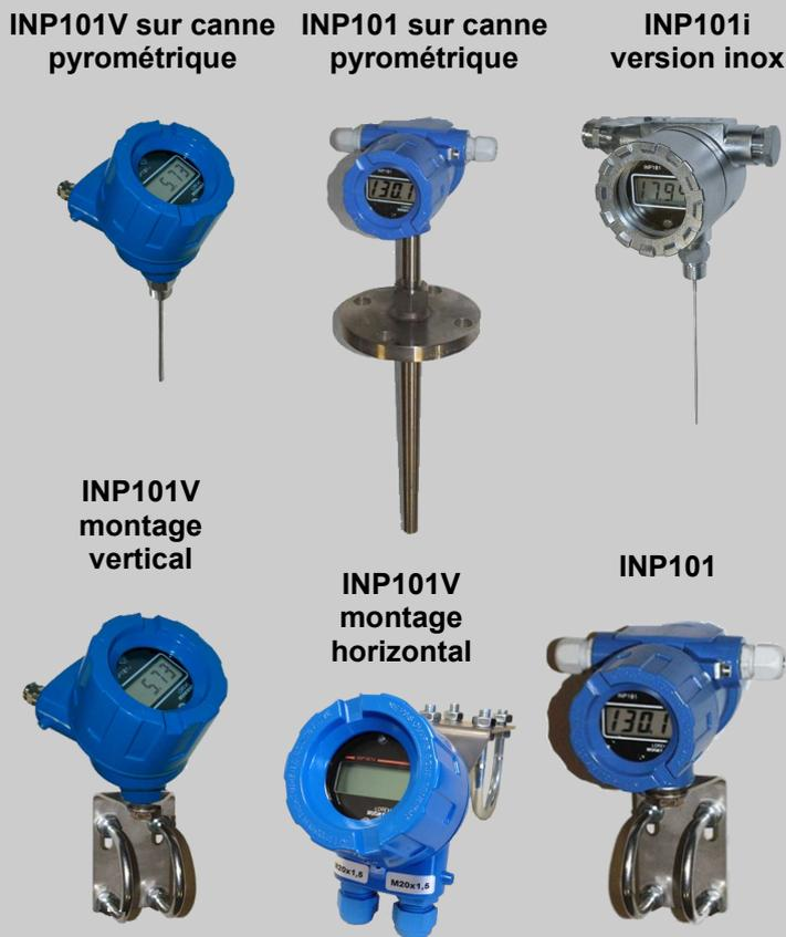
L'INP101 est un transmetteur- indicateur de terrain autoalimenté par la boucle 4...20mA. Il regroupe dans un seul boîtier résistant à des environnements sévères (IP 67) un convertisseur programmable (CNL40IG en technique 2 fils) ainsi qu'un indicateur numérique 4 digits.
